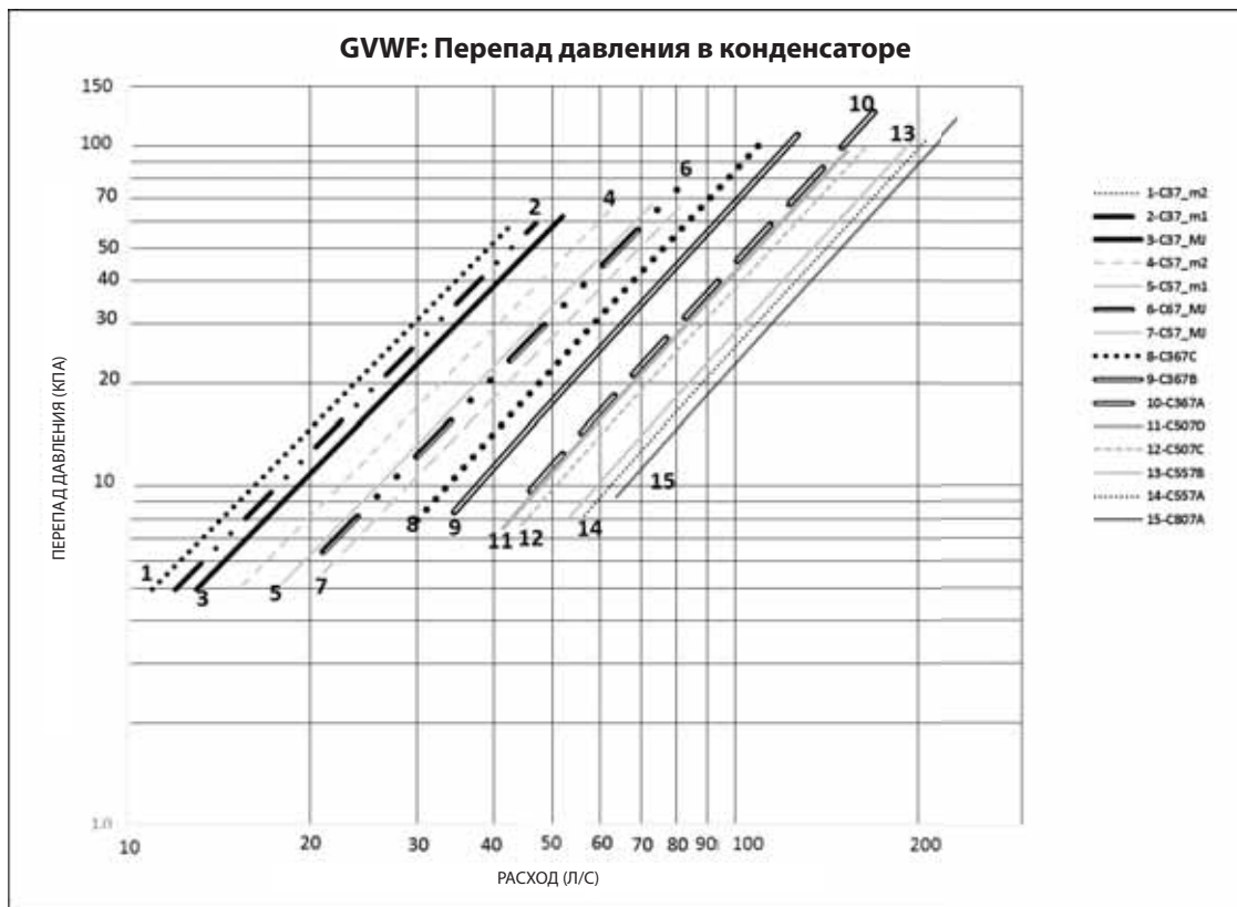
Рисунок 4. Падение давления на конденсаторе GVWF
